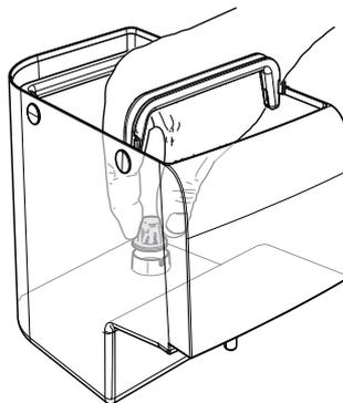
Den Wasserfilter in den leeren Tank einsetzen. Bis zum Einrasten drücken.
