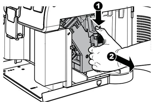
Den internen Behälter im hinteren Bereich anheben, um ihn zu lösen.
