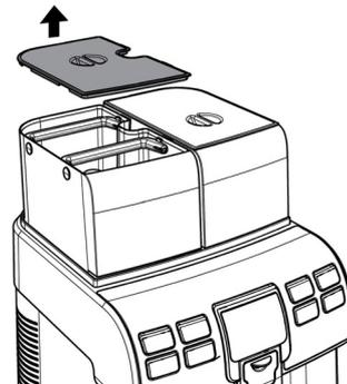
Den Tank entfernen; dieser wird an den im Inneren angebrachten Handgriffen angehoben.
