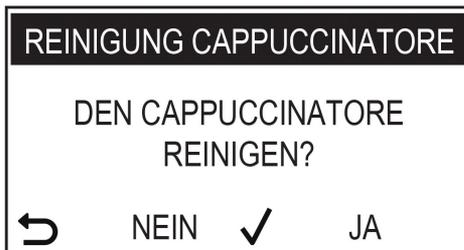
In diesem Fall erfolgt die Reinigung nur mit Heißwasser und umfasst nicht den Ansaugschlauch, dessen Reinigung nach Beendigung des Zyklus zwingend vorgeschrieben ist.
