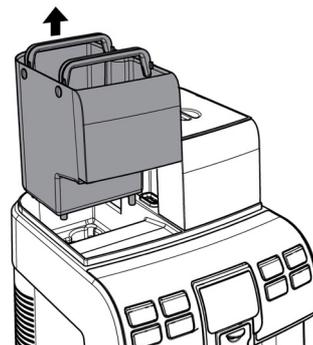
Ausspülen und mit frischem Wasser füllen; der im Tank angegebene maximale Füllstand (MAX) darf nicht überschritten werden.
