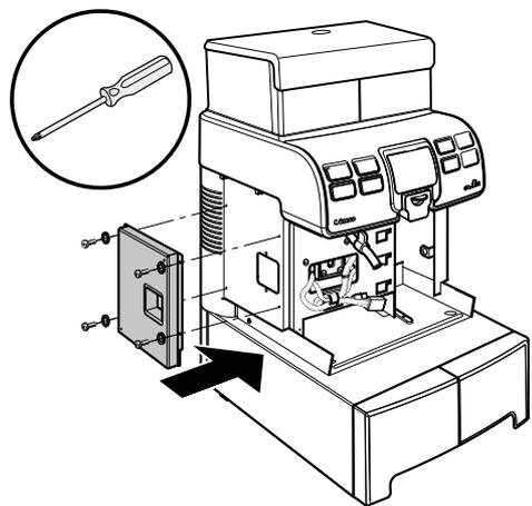
Die Maschine hat zwei unterschiedliche Steckverbindungen, eine quadratische für das Zahlungssystem "Apollo" und eine rechteckige für die Verbindung mit dem Münzprüfer.
