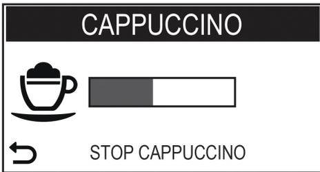
Die Maschine bereitet den Cappuccino in einem einzigen Ablauf zu. In diesem Fall wird durch Drücken der Taste "Spezialgetränke" die Ausgabe des ganzen Getränks beendet.
