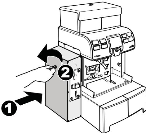
Die Frontblende wieder einsetzen und mit der vorher abgenommenen Schraube befestigen. Den Kaffeeauslauf wieder einsetzen. Die Abtropfschale wieder montieren.
