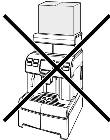
⚠ Aufgrund des Gesamtgewichts ist die Stapelung von mehr als drei Maschinen verboten. Die Maschine muss in der Originalverpackung trocken und/oder vor Staub geschützt eingelagert werden.
