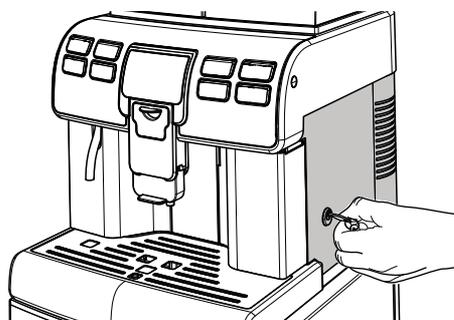
Die Brühgruppe herausnehmen, indem sie am entsprechenden Griff gehalten und die Taste «PRESS» gedrückt wird. Die Brühgruppe darf ausschließlich mit lauwarmem Wasser ohne Reinigungsmittel gereinigt werden.
