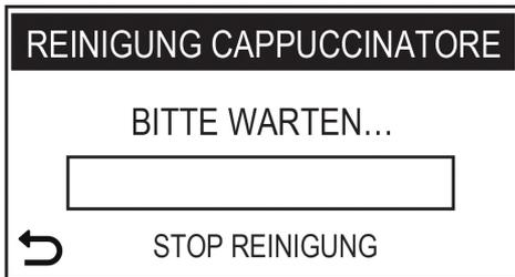
Nach Abschluss des Aufheizens führt die Maschine einen gesteuerten Reinigungszyklus des Cappuccinatore aus. Das Zyklusende abwarten.
