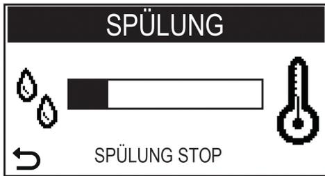
Der Balken zeigt den Fortschritt an und dass die Maschine den Spülzyklus des Systems ausführt.
