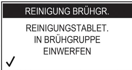
Die Reinigungstablette in die Brühgruppe einwerfen und die Brühgruppe wieder in die Maschine einsetzen. Darauf achten, dass alle Teile eingesetzt wurden und die Tür schließen.
