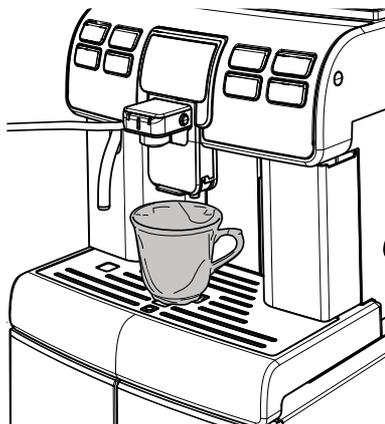
Die Taste "Cappuccino" gedrückt halten, bis die Meldung "MEMO" angezeigt wird und dann loslassen. Nun befindet sich die Maschine im Programmiermodus.
