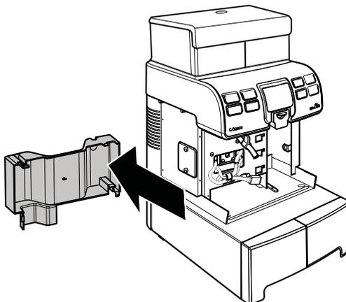
Die Frontblende wieder einsetzen und mit der vorher abgenommenen Schraube befestigen. Den Kaffeeauslauf wieder einsetzen. Die Abtropfschale wieder montieren.
