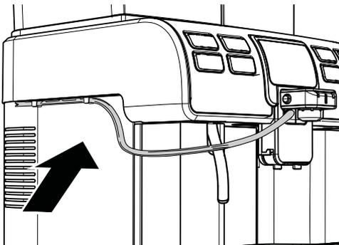
Sollte der Münzprüfer angebracht sein, muss der Schlauch wie in der Abbildung gezeigt, abgelegt werden.
