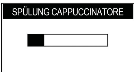
Die Maschine führt einen Spülzyklus des Cappuccinatore aus. Der Balken zeigt den Fortschritt der Spülung an.
