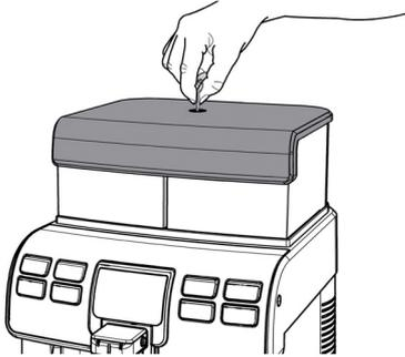
Nach der Entriegelung wird die Abdeckung durch Anheben entfernt.
