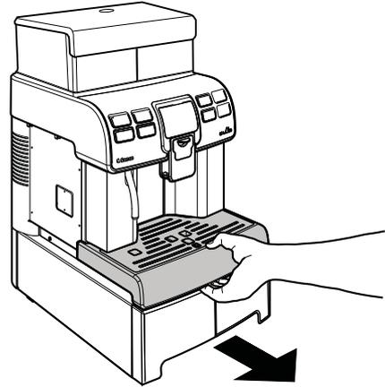
Die Abtropfschale leeren und reinigen.
