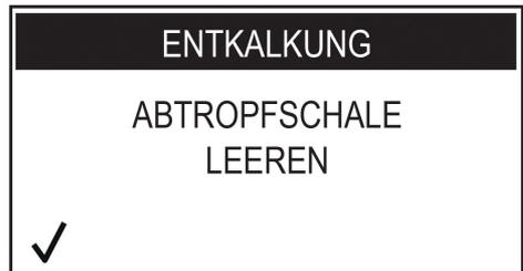
Alle vorhandenen Flüssigkeiten aus der Abtropfschale entleeren und die Abtropfschale wieder in die Maschine einsetzen. Die Taste "Kaffee" drücken.
