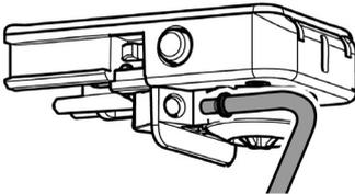
In diesem Fall kann der Ansaugschlauch in die Halterungen eingesetzt werden, wie in der Abbildung gezeigt.
