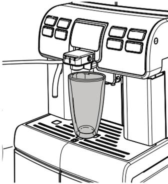
Ist die Maschine bereit, wird die Taste "Latte Macchiato" gedrückt, um die Ausgabe des Latte Macchiato zu starten. Die Maschine bereitet den Latte Macchiato automatisch zu. Nach der Benutzung muss der Cappuccinatore gemäß der Beschreibung im Abschnitt "Reinigung Cappuccinatore (nach jeder Benutzung)" gereinigt werden. Den Behälter entnehmen und, soweit erforderlich, dessen Reinigung vornehmen.
