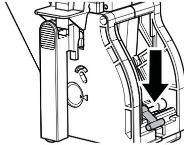
Sicherstellen, dass sich der Haken für die Sperre der Brühgruppe in der korrekten Position befindet; Um deren Position zu überprüfen, muss die Taste "PRESS" fest gedrückt werden.
