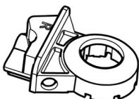
Schlüssel Ausschuss Sicherheit Tür: für die Ausschaltung der Sicherheit der Tür für die Einstellung des Mahlwerks.
