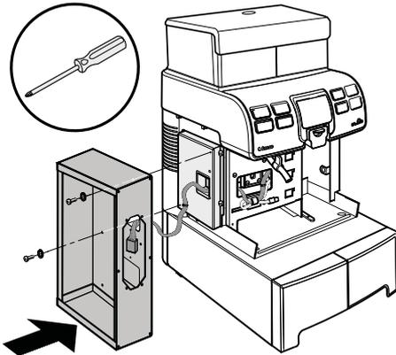
Das Verbindungskabel muss entsprechend im Gehäuse eingesetzt werden.
