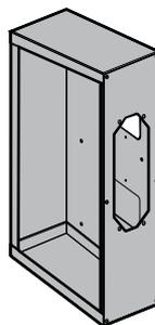
Das Gehäuse ist nur der Behälter, in dem der Münzprüfer für die vorschriftsmäßige Installation und als Schnittstelle mit der Maschine aufgenommen wird.
