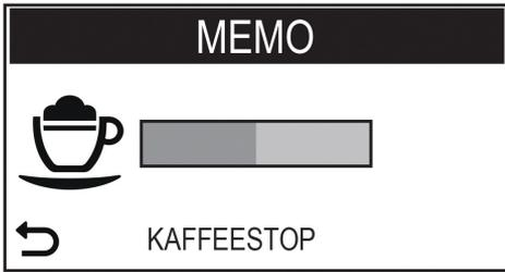
Ab diesem Zeitpunkt muss die Taste "Spezialgetränke" gedrückt werden, sobald die gewünschte Kaffeemenge in die Tasse ausgegeben wurde. Nun ist die Taste "Cappuccino" programmiert. Bei jedem kurzen Druck gibt die Maschine die soeben programmierte Menge aus.
