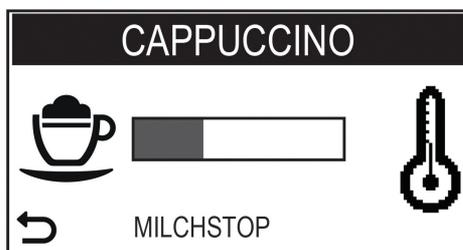
In dieser Phase gibt die Maschine die aufgeschäumte Milch aus. Die Ausgabe kann durch Druck der Taste "Spezialgetränke" beendet werden.
