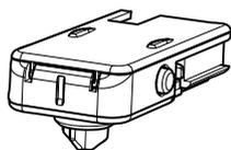
Linker Anschluss für Cappuccinatore: Der Milchbehälter kann an den Cappuccinatore angeschlossen werden, wenn auf der Maschine kein Münzprüfer vorhanden ist.
