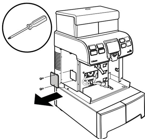
Distanzstück auf der linken Seite der Maschine anbringen und mit den 4 im Lieferumfang enthaltenen Schrauben befestigen.
