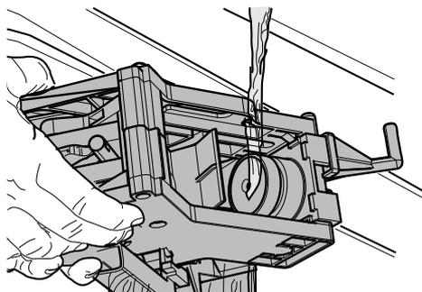
Den internen Behälter im hinteren Bereich anheben, um ihn zu lösen.
